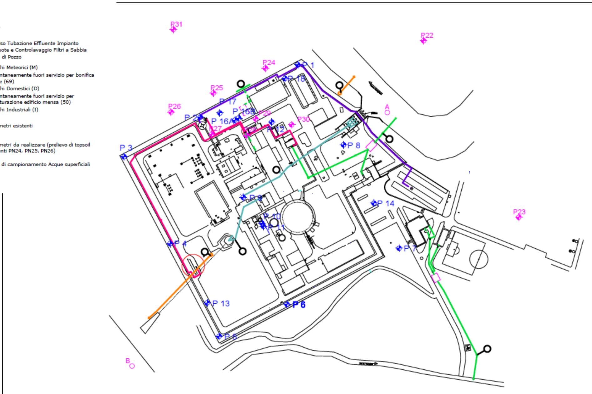
Figura 6-2 – Ubicazione dei piezometri proposti per il monitoraggio preliminare (Piano della caratterizzazione)
