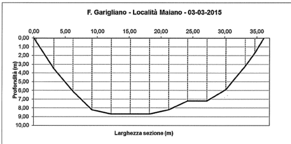
Figura 4-1 - Profilo della sezione di misura
