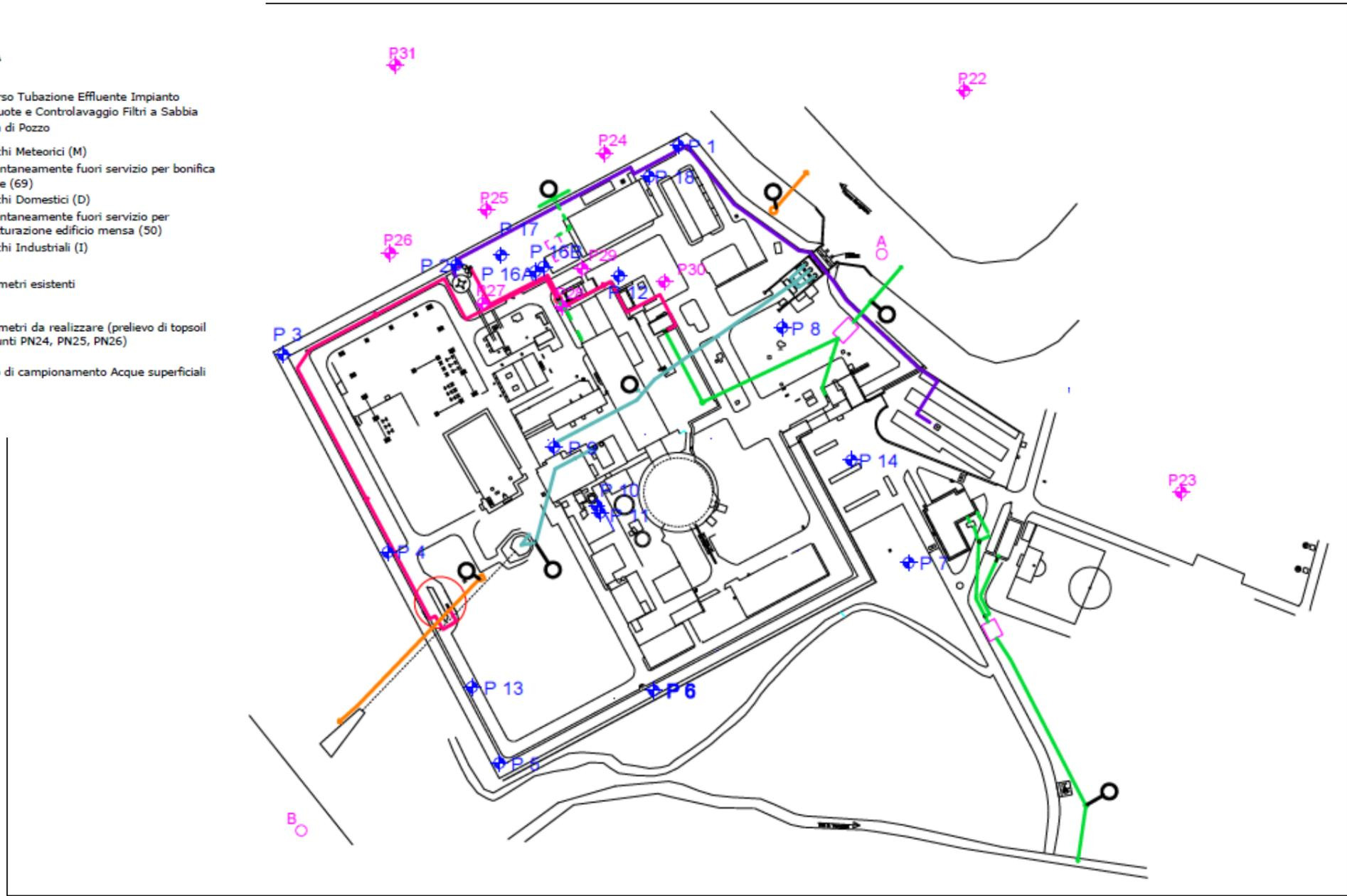
Figura 6-2 – Ubicazione dei piezometri proposti per il monitoraggio preliminare
